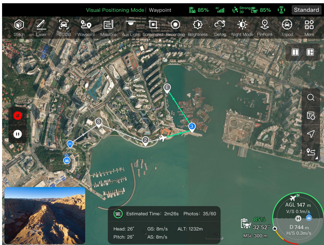
Fig 6-21 Mission de point de repère en cours
